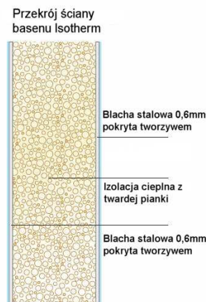
Przekrój ściany basenu
